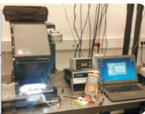
Stanowisko do pomiarów ogniw fotowoltaicznych
